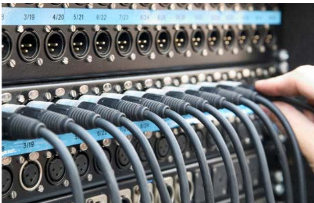
Figura. Identificación de conectorizado de líneas de transmisión en sistemas de producción de audio.
